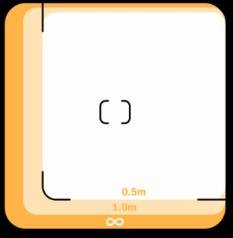
整個取景器代表一張以∞取景的照片。當距離拍攝物件8米以內時，請確保其在取景框內居中：1.鎖定焦點；2.調整取景框。
