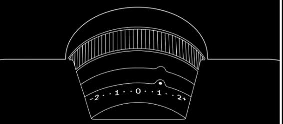
在所有其他模式下，相機將嘗試自動選擇正確的曝光 (0)。但是，如果您使用EV旋鈕來補償曝光，顯示幕上將會顯示。
