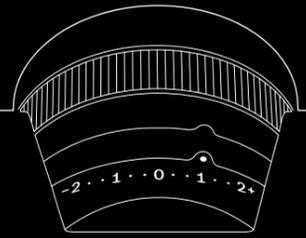
在所有其他模式下，相机将尝试自动选择正确的曝光 (0)。但是如果使用EV旋钮来补偿曝光，显示屏上将会显示。
