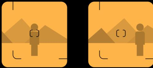
半按快门按钮也会锁定曝光并对焦在拍摄对象上。对于对焦清晰、偏离中心的拍摄对象：保持半按按钮，重新对准自动对焦框，然后拍摄。
