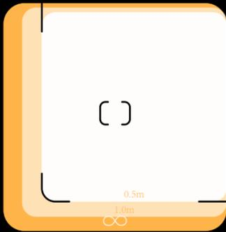
整个取景器代表一张以∞取景的照片。当距离拍摄物件8米以内时，请确保其在取景框内居中：1.锁定焦点;2.调整取景框。
