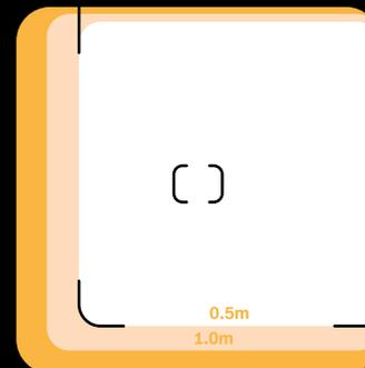
ビューファインダー全体は、∞でフレーミングした写真を表します。被写体が8mより近いとき、被写体が8mより近くなると、1. 焦点をロックし、2. フレーミングを調節して、その被写体がフレームの中心に来るようにすることができます。
